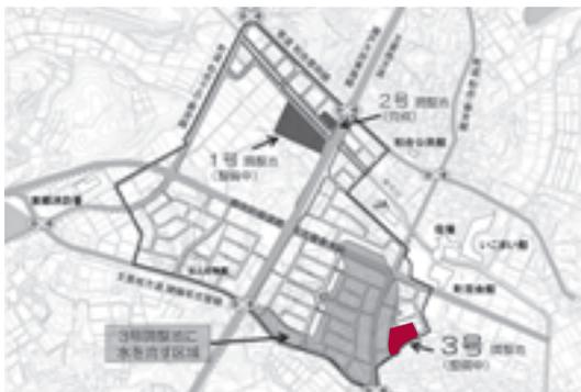
調整池は、大雨の時に雨水をいったん貯めて、少しずつ排出することで下流の河川の氾濫を防ぐための施設で、近年多発する大型台風やゲリラ豪雨に対しても効果があります。
