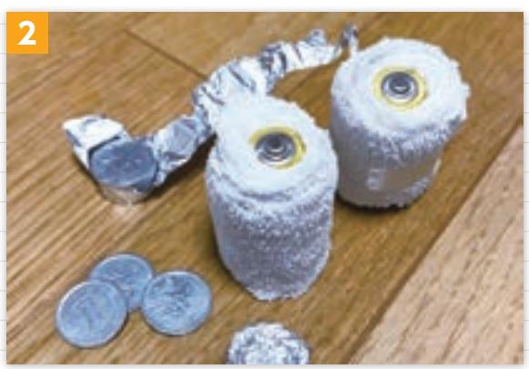
2 布や段ボールを必要なサイズの太さになるまで電池に巻いて、テープで止めます。(今回は、タオルを巻きました)
