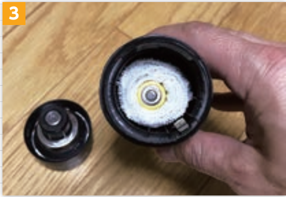
3 懐中電灯などに大きさを变えた電池を入れ、アルミホイルや1円玉で長さを調整すると使うことができます。
