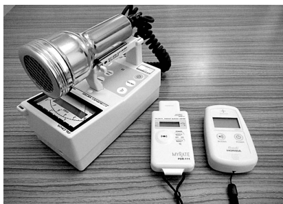
放射線測定器：左1台／表面汚染用 右2台／空間放射線量用
